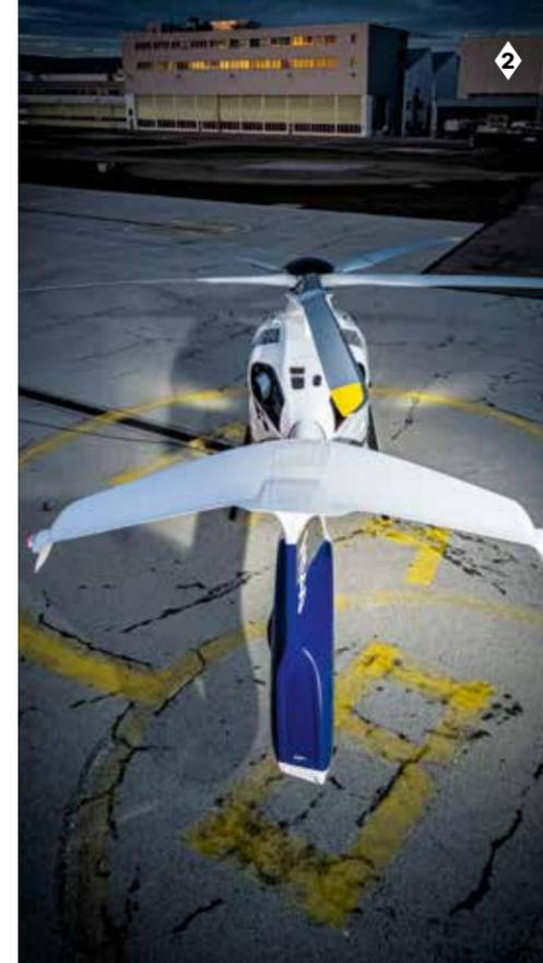
composite fait d'une seule pièce. « Le carénage, les ailettes du stator et le montage de la boîte de transmission arrière sont réalisés en une fois avec le même outillage », précise-t-il. « La conception intégrée d'une pièce très complexe représente un avantage, car elle nous permet de fournir plus de fonctions dans une seule pièce. Cela réduit sensiblement les délais d'assemblage ainsi que le poids et les coûts, tout en améliorant la performance. »
