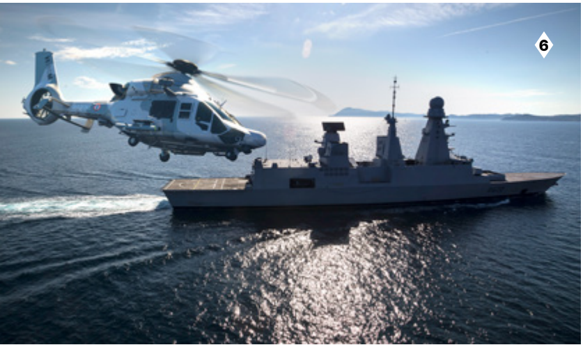
4: Die fünf Blue Edge-Rotorblätter reduzieren den Geräuschpegel der H160M und sorgen dafür, dass kritische Einsätze diskreter durchgeführt werden können.
