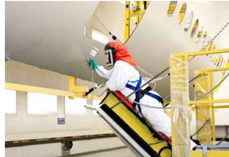
Lackieren von CFK mit chromatfreien wasserbasierten Grundierungen
