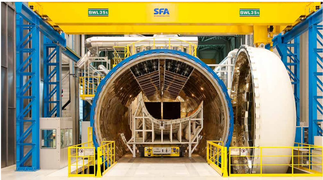
Aushärtetechnik für Faserverbundbauteile im Großautoklav bei Vakuum und Druck
