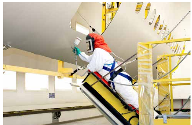
Lackieren von Großkomponenten aus Faserverbundkunststoff
