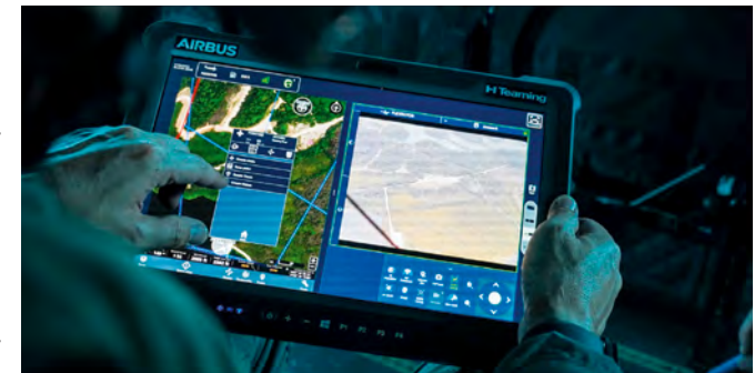
► Zoom sur la tablette du système HTeaming, qui fournit à l'équipage les informations recueillies en temps réel par le Flexrotor.
